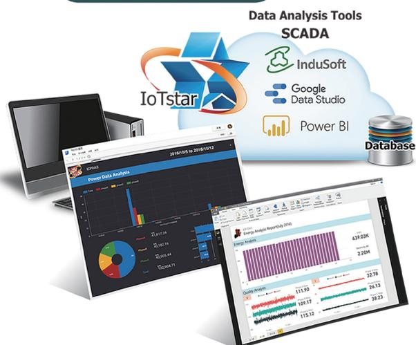
透過開放式資料庫 (SQL) 介面的支援，IoTstar 所儲存的感測器數據能與第三方雲端管理平台、資料分析工具 (如：Power BI、Google Data Studio、SCADA 系統)、ERP/MES 系統連接，協助管理人員快速整合 OT (Operational Technology) 與 IT (Information Technology) 系統，提供全方位且完整的系統運作資訊。
